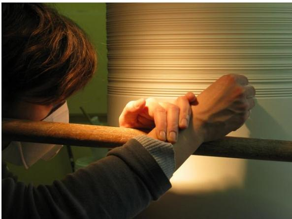
De fines stries horizontales, d'une hauteur et d'une profondeur variable, sont obtenues par tournassage<sup>3</sup> à l'aide d'un peigne en métal appliqué sur la pâte crue sur toute la hauteur du vase (*fig. 2*), avant une première cuisson de dégourdi à 960° C, puis un passage au four à 1260° C pour fixer l'émail préalablement appliqué à l'intérieur.
